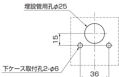
①灯具を取付ける位置を確認して、埋設管用孔Φ25をあけてください。
