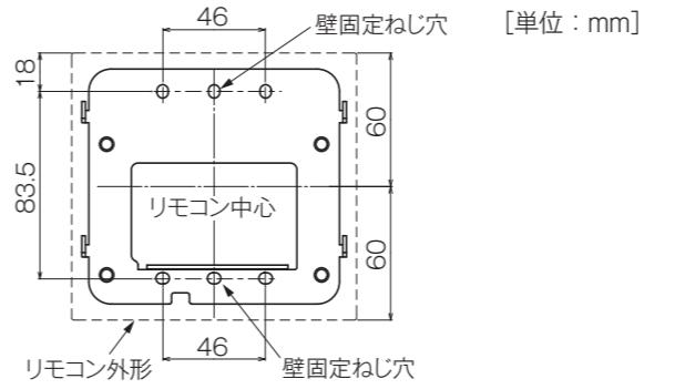
※壁取付金具が台所リモコンから取りはずしにくい場合は、壁取付金具とリモコンの隙間に $\ominus$ ドライバーを差し込み、ゆっくり回してはずしてください。
