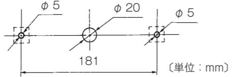
②浴室リモコン取り付け用穴の外側に補強用の木片を取り付けてください。
