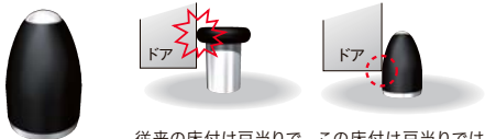
床付戸当り CSA-354 カラー:塗装シルバー 従来の床付戸当りではドアの面に当たるため補強のない部分に当たるとドアが凹んでしまいます。 この床付戸当りではドアの角が当たるため凹みづらくています。
